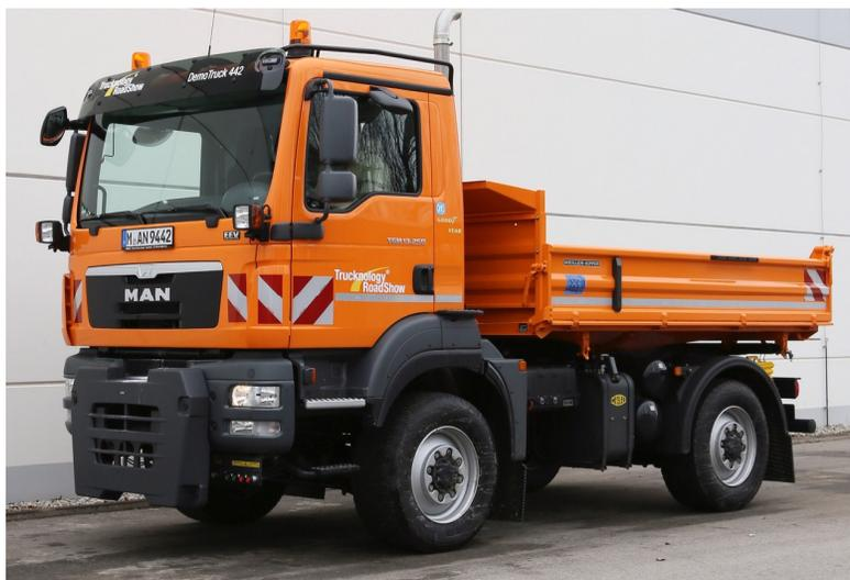
**Attenzione: verificare sempre bene nei TGM 4x4 che le masse anteriori ammissibili siano compatibili con l'allestimento e la lama che si vuole montare! Specialmente se si ha la gru retrocabina!**
