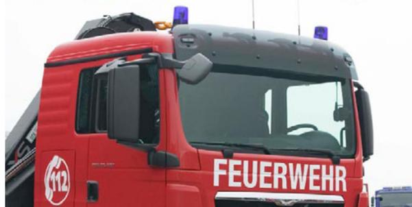
**352FD Predisposizione per luci rotanti su tetto cabina. Viene fornito il cablaggio e l'interruttore, non le luci.**
